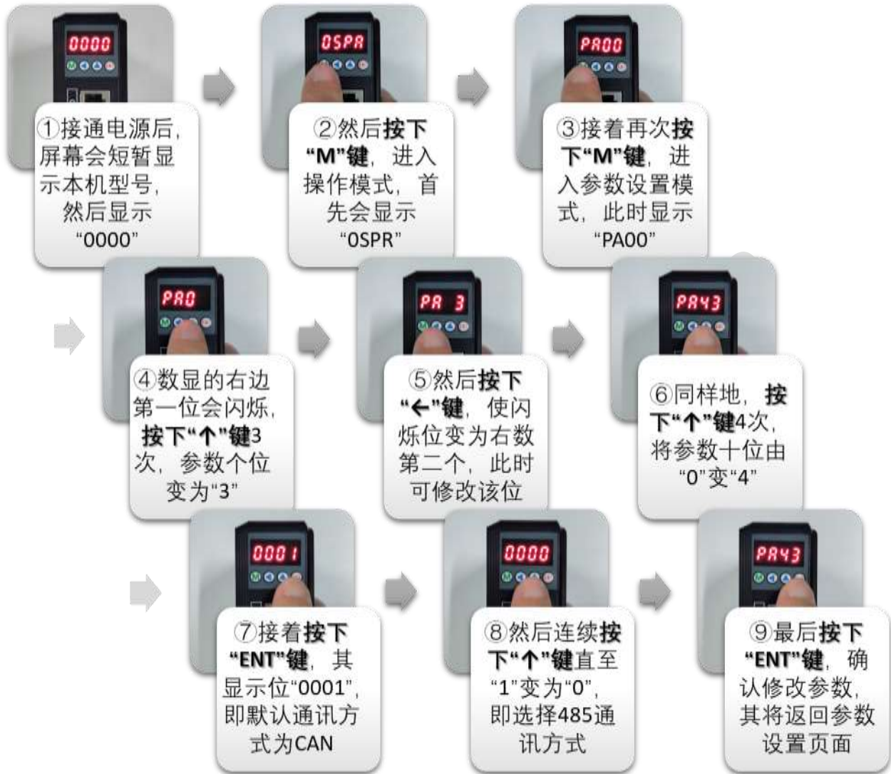
图 182DM556-R/RC 按键面板参数 P43 设置流程图
