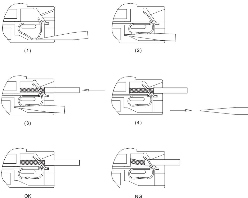
注：在使用绝缘保护直径为2mm以下的导线时，请勿将导线的绝缘部分插入弹簧夹开口处。
