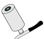
步骤2：用3mm六角扳手设定注油时间(1~12个月，建议顺时针拧动)，当设定后注油器立即被启动。
