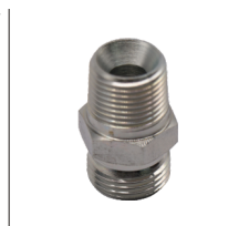
英制BSP螺纹-外螺纹-60°锥面密封和带O型圈密封
