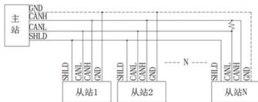
图 22 CAN 总线网络接线示意图
