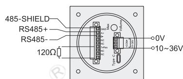
① 仅RS485总线末端的两个设备需要接120Ω终端匹配电阻。
