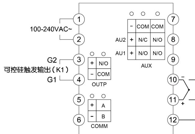
注1：根据负载的电压及电流大小选择压敏电阻以保护可控硅，负载为感性或采用移相触发时必须加阻容吸收。
