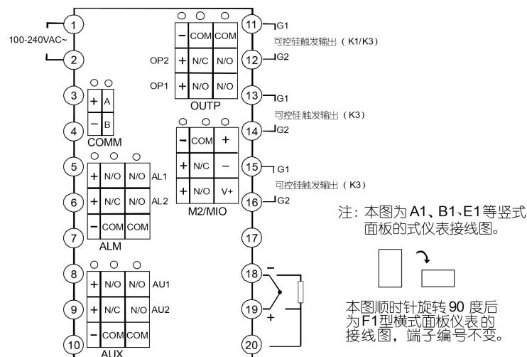
D61型面板仪表（48X48mm）接线图如下：
