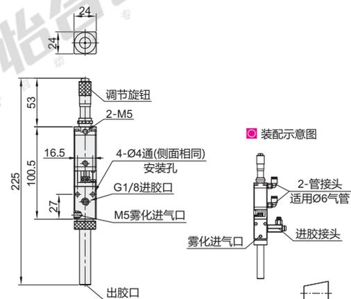
管接头和进胶接头是标配件，安装后同点胶阀一起发货，实物参考安装示意图。
