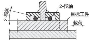
内部设置有沿轴向的双向楔形机构，当楔形机构压下时，预压把两条滚轴都压在楔角内，从而将本体和滑动板材锁紧。
