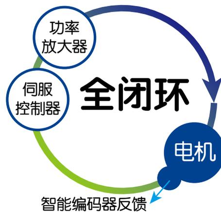
普通编码器只有 A/B 信号，电机的初始对位通过给电机绕组通电锁轴来实现。如果没有摩擦负载，锁轴对位是比较准确的。如果有摩擦负载存在（例如垂直轴的应用），初始对位会产生电角度的误差，这会产生力矩损失。摩擦负载越大，力矩损失越大。当摩擦负载大到一定程度，可能导致电机无法运行甚至飞车。
