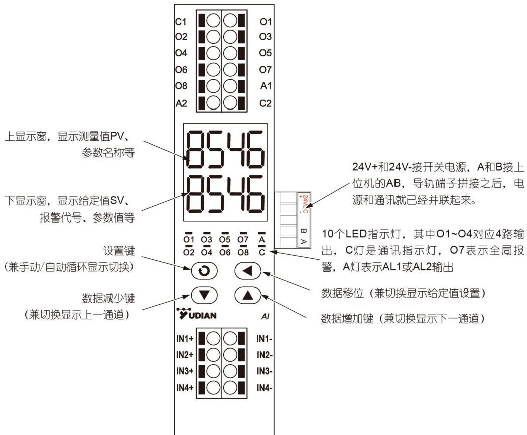
4 路热电偶输入接线分别接 INX+ 和 INX-，以第一路为例，IN1+接热电偶的正，IN1-接热电偶的负。
