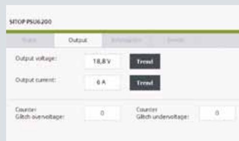
实时监控 PSU620 输出参数
