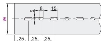
W≥80mm线槽底部孔尺寸
