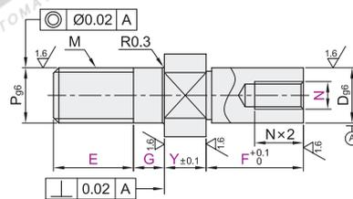
① 工艺孔加工条件：总长度除以D段长度>3。(工艺孔详细尺寸见产品简介)
