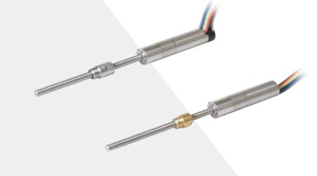
鸣志直线空心杯电机采用具有自主专利技术的空心杯绕组,为我们带来高转速、高扭矩、低噪音的优势。由于 没有齿槽效应以及其结构紧凑,我们能得到更平稳的高低速运行、更精确的控制以及更高的效率和功率密度。 创新性地将滚珠丝杠或螺纹丝杠与空心杯电机集成一体,为客户使用带来便利,并且有效为客户节省空间,提 高模块稳定性。
