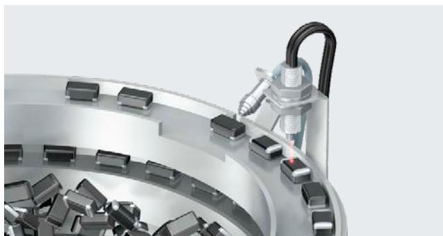
部件正反检测时的吹气输出
