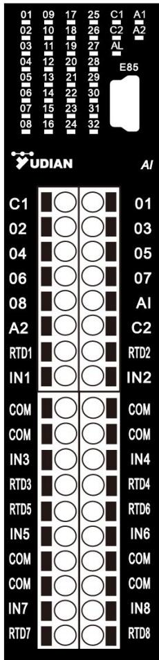
D92 尺寸本身无显示器及键盘，可通过 RS485 通讯接口与上位机计算机或触摸屏连接来完成其显示界面的功能及操作。也可以利用外接的 E85 型键盘及显示器进行显示及参数设置。
