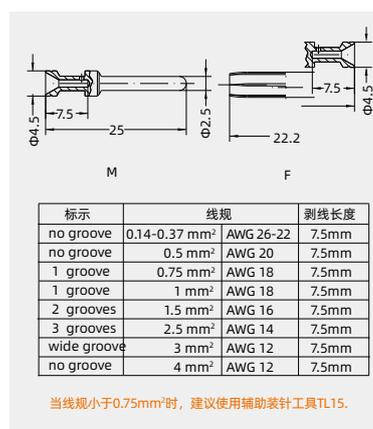
注意事项：冷压压接的工具关系到产品的品质稳定性，请选择我司认证的工具。
