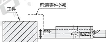
请结合工件形状，准备好前端部件。借助弹簧的弹力横向将工件压入固定。
