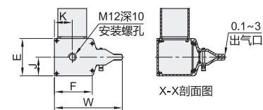
安装方式：B2(螺杆安装)
