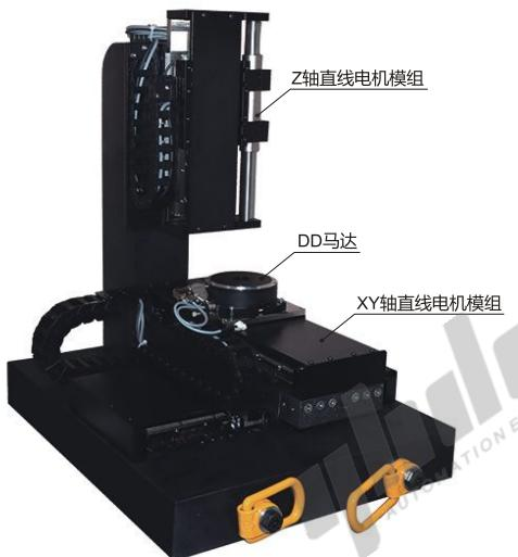
● Z轴直线电机模组是自动化设备中常用的一种组件，主要用于实现上下方向（即垂直方向）的运动。DD马达用于需要旋转运动。
