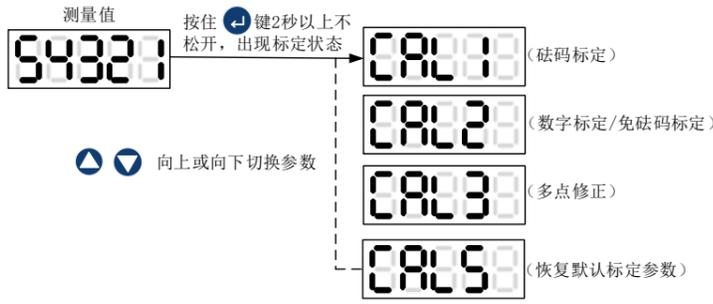
**CAL1: 砵码标定**—采用实物标定的方法。零点标定时传感器空载, 增益标定时加载实物测量满量程。
