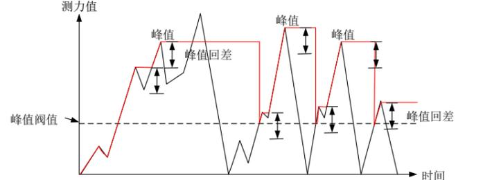
如上图所示，当测量值超过峰值阈值设定值后，仪表开始检测峰值；当测量值回落幅度超过峰值回差设定值后，锁存当前检测到的峰值，测量值低于阈值后停止检测，获取到峰值。
