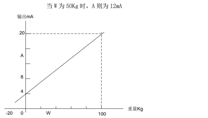
**F8-07：微调第一点模拟量**和**F8-08：微调第二点模拟量**—模拟量显示有偏差时，可进行微调。
