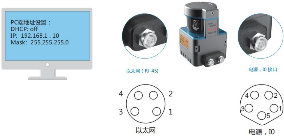
图 3 LR-1BS 电气接口示意
