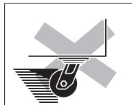
使用速度75mm以下的不超过2km/h, 100mm以上的不超过4km/h。
