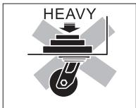
绝对不能超过说明的最大载重，超负荷使用是造成事故的原因，4轮以上同时使用时的安全率为最大负载的80%。
