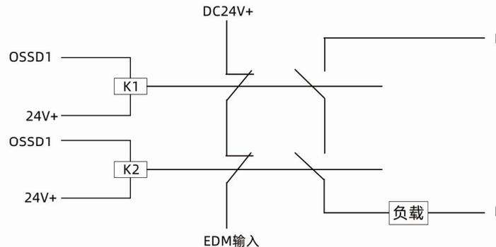
如上图所示，此处以光幕输出NPN负极信号为例，OSSD1和OSSD2为两路安全输出，K1和K2为继电器线圈。继电器需具备两组独立触点，一组用来正常控制负载，另一组触点用来检测EDM输入，EDM线通过继电器的常闭触点串联后接到电源正极。继电器的常开触点串联后连接到安全控制回路。当遮光时，光幕的EDM线若与电源正极不导通，则可判断K1 K2中至少有1个继电器失效，光栅进入锁定状态，指示灯报警。
