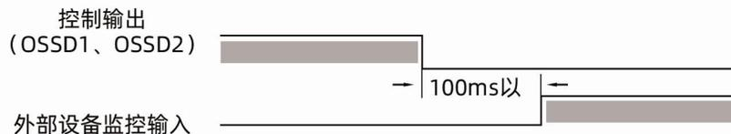
如上图所示，安全光幕由透光变为遮光，安全输出由ON变为OFF后100ms内，继电器应动作。当任一继电器响应时间超过100ms或不动作时，安全光幕锁定。在正确使用EDM功能情况下，安全光幕出现EDM锁定状态时，应检查继电器是否出现触点粘连和响应延迟故障。不便检查故障时，可使用逐个替换继电器的方法排查。
