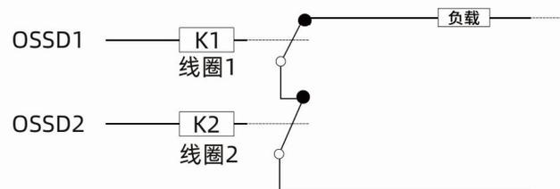
双信号独立控制两个继电器线圈 (K1、K2) 并通过输出触点串联成一路来控制负载电路, 如果一路信号失效, 另一路信号依然可以起到保护作用。
