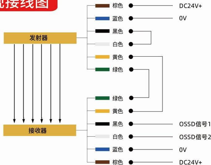
①双信号接入PLC时, 需接两路独立输入点
