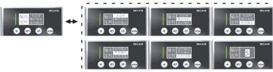
(8) 显示模式：标准（实际距离）、反转（量程中心点为0点，靠近传感器方向为正值，反之负值）、偏移（量程最远处为0点，靠近传感器方向距离增大）。
