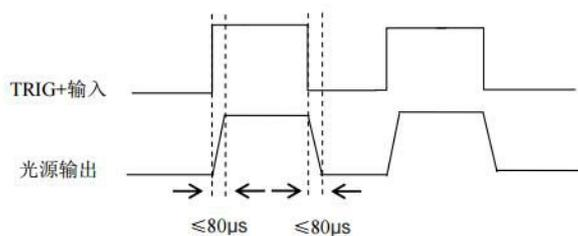
常灭模式：当外部连接触发信号时，触发“+”“-”输入端口断开（高电平），光源常灭；“+”“-”输入端口短接（低电平），光源常亮。
