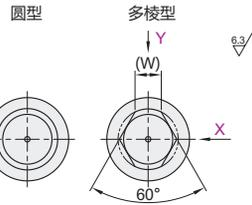
① 多棱型时, 根据X、Y 选择止动螺丝的位置。
