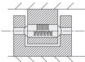
借助一定压力的弹簧双向推动球体的运动，起到定位作用。
