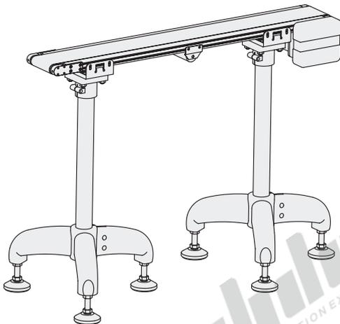
① 使用说明：弧三角支座适用于支撑位置需要调整的输送机。
