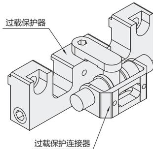
① 此组合件包括安装在滑座上的过载保护器，和安装在同步带上的连接器。当滑座的运动受阻，过载保护器所受阻力达到设定值（通过调节两端的内六角紧定螺钉设定力值），过载保护器便会从同步带上的连接器分离，从而保护整套设备。
