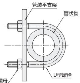
U形螺栓，两头有螺纹可与螺帽结合；主要用于水管和其他固定管配件或板件。例如：汽车钢板弹簧的建造和安装、机械连接、车辆、轮船、桥梁、隧道、铁路等。
