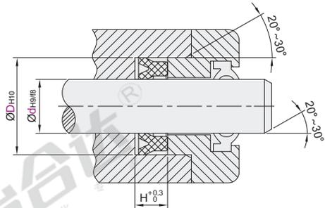
② 活塞杆表面应作0.2~0.4μm Ra的抛光。
