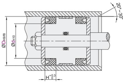
① 活塞缸内面应作0.1~0.8μm Ra的研磨或抛光。
