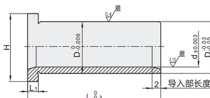
① 直柱型、肩型衬套固定方法，建议使用乐泰胶粘接。
