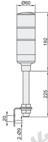
安装底座: 带底座的支撑管安装
