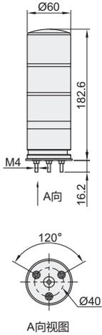
安装底座: 支撑管安装
