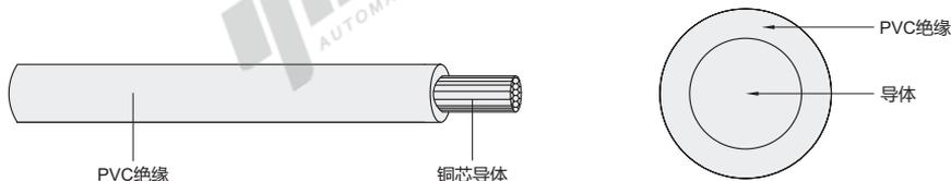
RV铜芯聚氯乙烯绝缘软电缆
