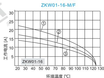
①线径: 2.5mm<sup>2</sup> ②线径: 1.5mm<sup>2</sup> ③线径: 1.0mm<sup>2</sup>
