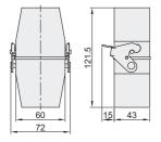
芯数:6芯 锁扣方式: 2L(双扣) 出线方式: CCT(空中对接)
