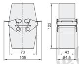
芯数: 16芯 锁扣方式: 2L(双扣) 出线方式: CCT(空中对接)
