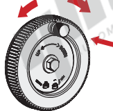
粗调 按下微调旋钮, 旋转手轮进行粗调。
