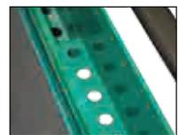
工具插孔, 方便插放撬棒、扭力扳手等超长工具
