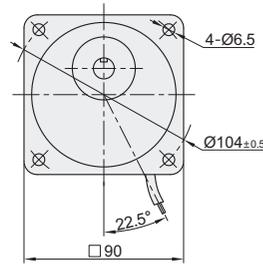
法兰型GU减速机+电机
