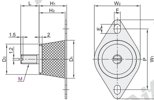
① 规格为1812、2517的螺纹顶端无扳手开槽。
