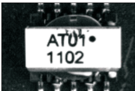
(1) IC管脚表面字符及缺陷检测
