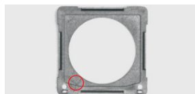
(4)表面裂纹检测
