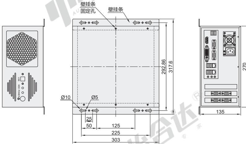
工控机有壁挂条2个及壁挂条固定螺丝。
