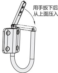
① 可左右旋转90°(不使用时可旋转折叠, 不会造成妨碍。)具有摩擦功能(摩擦阻力), 可防止左右摆动, 可在任意角度停止。
