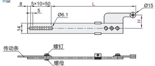
装配方式: 用螺钉与扁式传动条连接固定, 连杆可通过变换固定孔调节长度, 每移动一孔可调节5mm.
