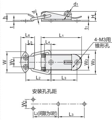
※扣板在弹簧力的作用下自动关闭, 解锁后也不会晃动。
