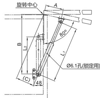
开门后，只要在主体的Ø6.1孔内插入螺丝刀等将其锁定，即可安全地进行作业。
