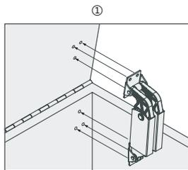
用安装螺钉将本体部安装在框架上。不使用附配“侧板托座”和“十字槽圆头小螺钉”。
