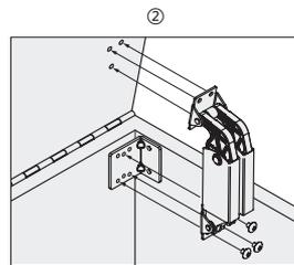
用附配螺钉将本体部固定于侧板托座后，再用安装螺钉将本体部安装在框架上。
